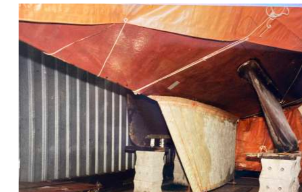
En met zelf gegoten midkiel!
